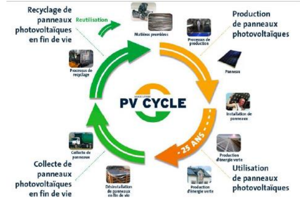
Figure 3 Cycle de vie des panneaux photovoltaïques (source : PV CYCLE, 2015)
